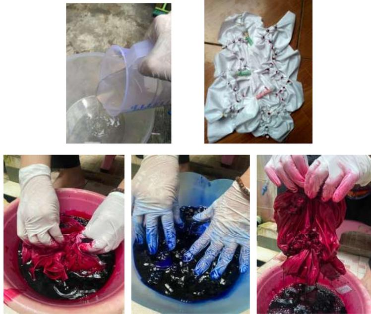
**Gambar 3. Proses mencelup dalam zat warna**
